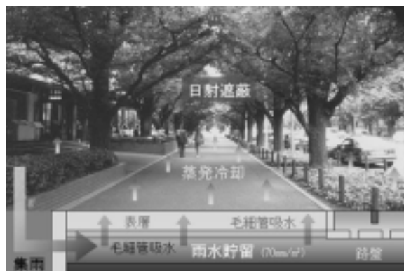
図2 蒸発冷却舗装システムの基本構成と適用空間のイメージ
